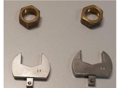
Hauswasserzähler werden mittels Verschraubungen in der Rohrleitung installiert. Oft ist der vorgeschriebene Wasserzähler-Einbaubügel nicht vorhanden. Die Muttern der Anschlussverschraubungen werden mittels Maulschlüssel oder in vielen Fällen mit einer Rohrzange angezogen. Dies entspricht nicht den fachmännischen Gegebenheiten.
